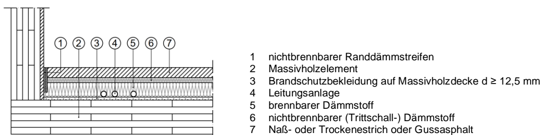
Prinzipskizze 3: Führung von Leitungsanlagen in Fußbodenaufbauten mit Kontakt zu brennbaren Dämmstoffen (Vertikalschnitt)
