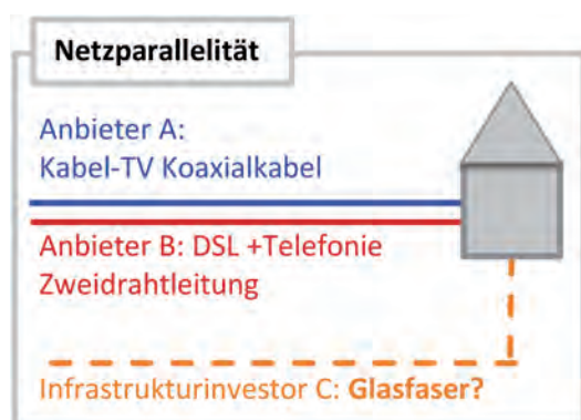
Abbildung 24: Parallelität von Kupfer- und Glasfasernetzen
