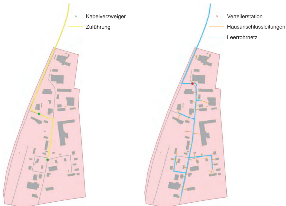
Abbildung 22: Vergleich FTTC-Überbau (links) und FTTB-Ausbau (rechts)
